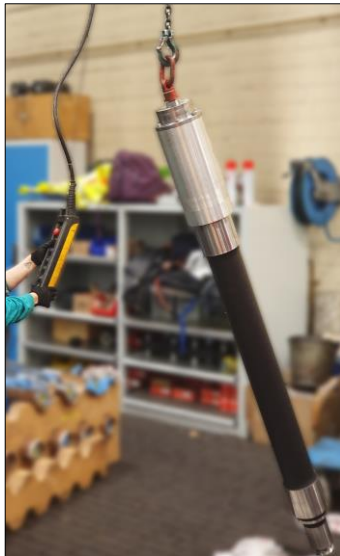
Abbildung 29: Transport der Radsatzwelle (Beispiel)
