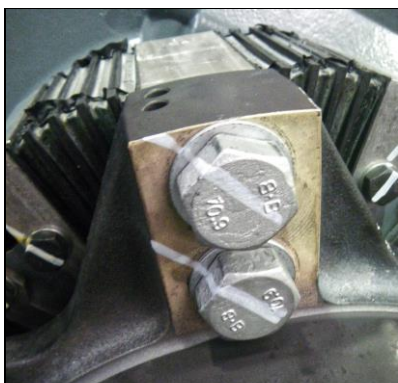
Abbildung 50: Manipulationssicherung (Beispiel)
