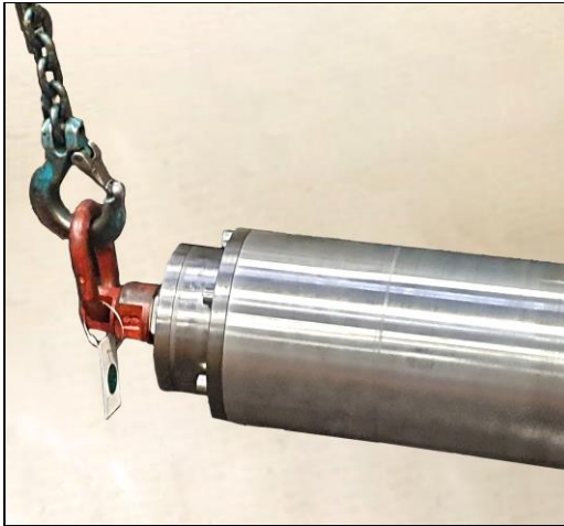
Abbildung 28: Hebezeug an der Hülse befestigen (Beispiel)
