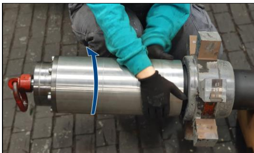
Abbildung 39: Temperatur am Achsstern messen (Beispiel)
