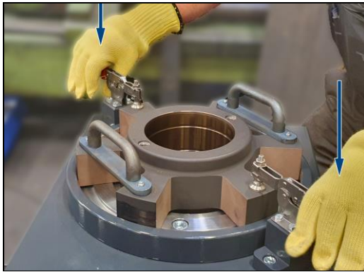
Abbildung 34: Achsstern in der Montagevorrichtung fixieren (Beispiel)
