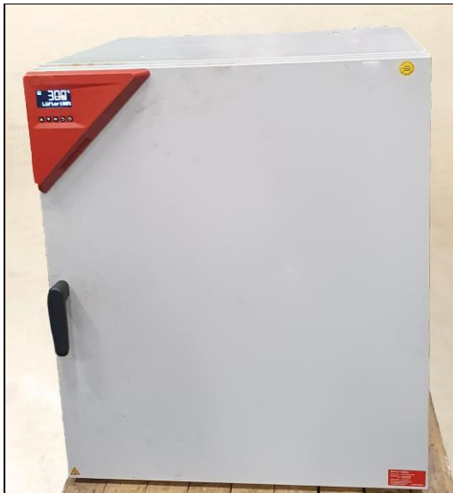
Abbildung 22: Ofen zum Erhitzen von Metall (Beispiel)
