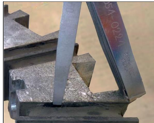
Abbildung 66: Risstiefe in den Gummielemente des Keilpaketes messen (Beispiel)
