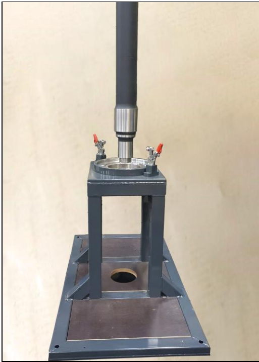
Abbildung 30: Radsatzwelle positionieren (Beispiel)
