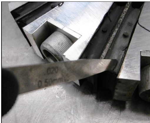
Abbildung 66: Risstiefe in den Gummielemente des Keilpaketes messen (Beispiel)
