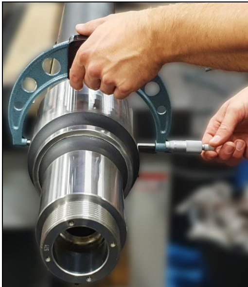
Abbildung 18: Durchmesser des Wellensitzes messen (Beispiel)
