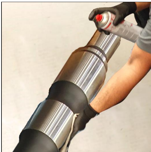
Abbildung 24: Wellensitz reinigen (Beispiel)
