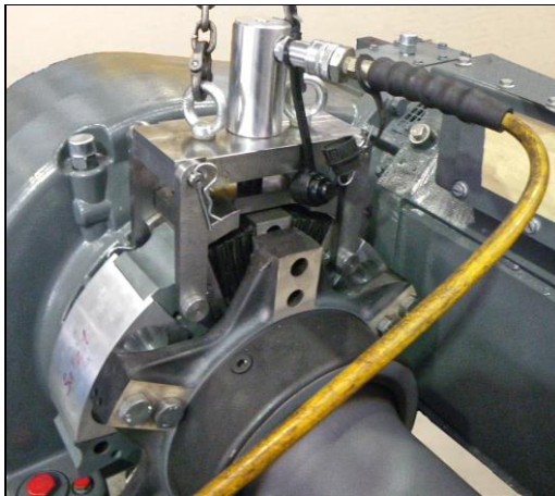
Abbildung 85: Montagevorrichtung im angebauten Zustand (Beispiel)
