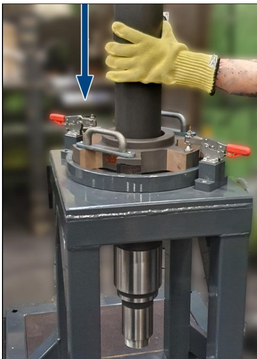
Abbildung 35: Radsatzwelle einführen (Beispiel)
