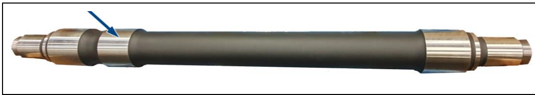
Abbildung 25: Radsatzwelle (Beispiel)
