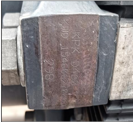
Abbildung 10: Gravur an der Zwischenwelle zur Identifikation der Kupplung (Beispiel)
