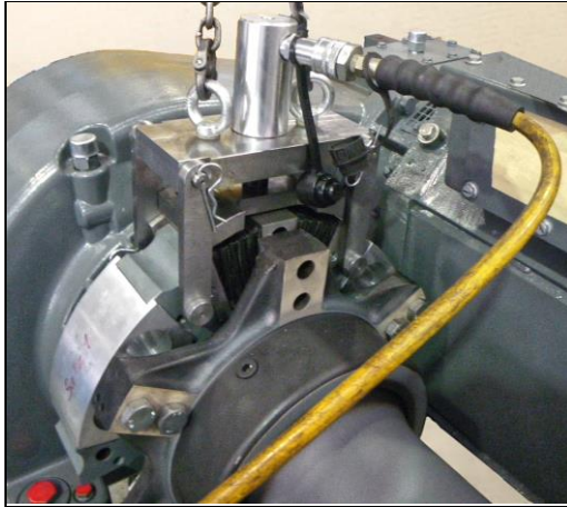
Abbildung 76: Montagevorrichtung im angebauten Zustand (Beispiel)
