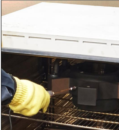
Abbildung 23: Temperatur am Achsstern messen (Beispiel)
