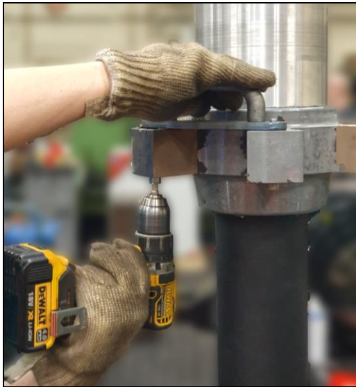
Abbildung 38: Transportgriffe entfernen (Beispiel)
