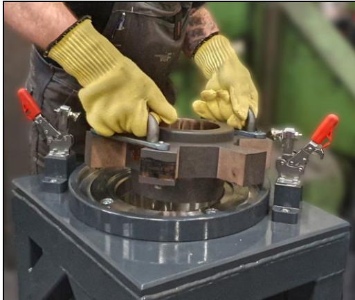
Abbildung 32: Achsstern in die Vorrichtung legen (Beispiel)
