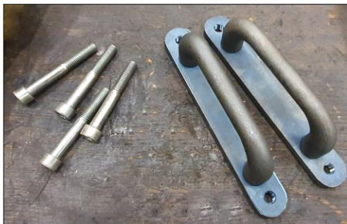
Abbildung 21: Transportgriffe montieren (Beispiel)
