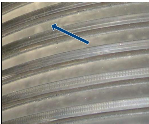
Abbildung 67: Weißgrauer Belag auf einem Gummielement (Beispiel)
