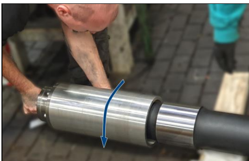
Abbildung 27: Durchmesser des Wellensitzes messen (Beispiel)
