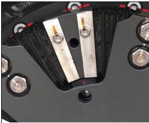
Abbildung 53: Manipulationssicherung (Beispiel)
