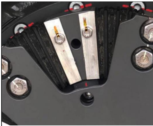
Abbildung 81: Manipulationssicherung (Beispiel)
